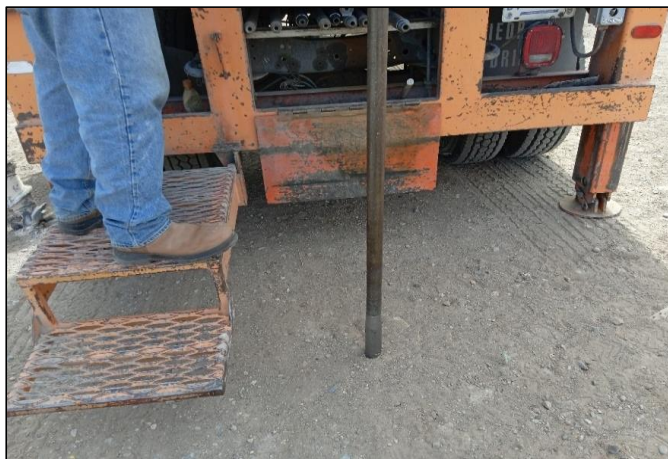
PRUEBA DE PENETRACION ESTANDAR EN SPT-1
