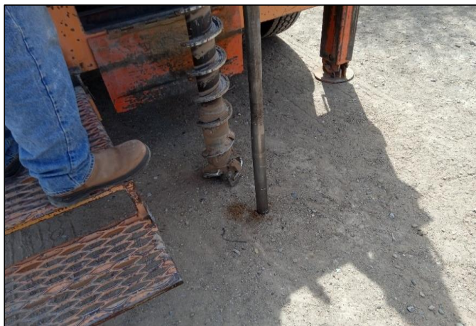
PRUEBA DE PENETRACION ESTANDAR EN SPT-2
