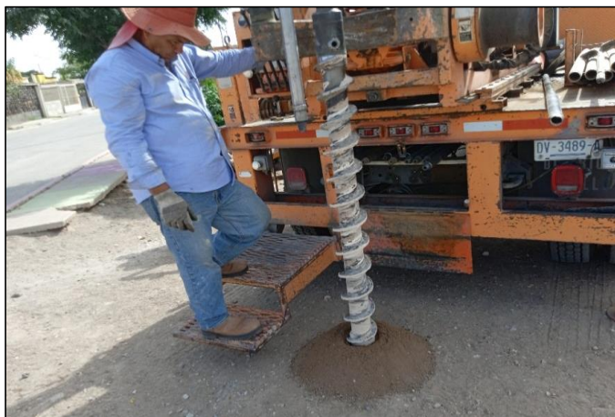
PERFORACION EN SONDEO SPT-1
