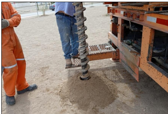
PERFORACION EN SONDEO SPT-3
